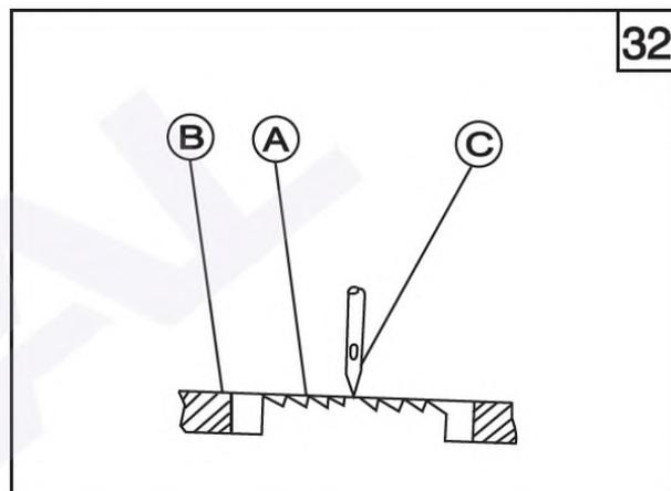
Отрегулировать можно путем изменения положения эксцентрика подъемника зубчатой рейки и эксцентрика подачи материала.
