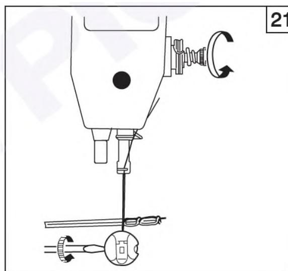
верхней нити. Или с помощью маленькой отвертки затянуть винт на шпульном колпачке, чтобы усилить натяжение нижней нити.
