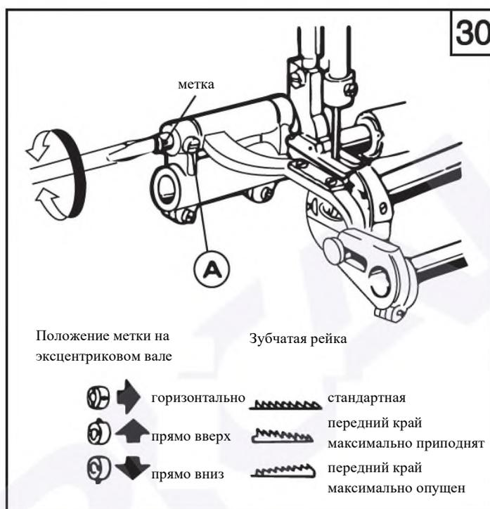
Если приподнять передний край зубчатой рейки, это позволит предотвратить сморщивание материала и пропуски стежков.
