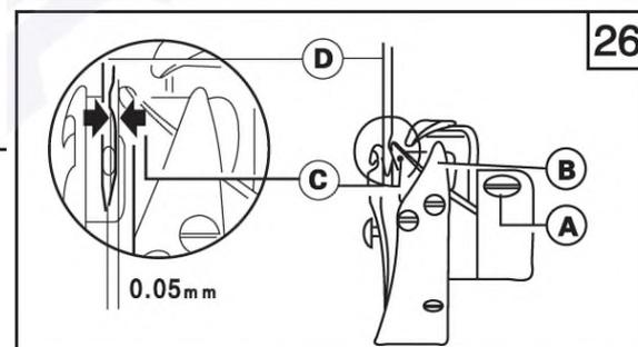
эффективность шитья. Стандартная синхронизация: поверните рукой маховое колесо, чтобы игла опустилась в максимальное нижнее положение, а затем поднимите снова на 2.5 мм. В это время, крючок для захвата нити вращающегося челнока (D) должен быть на одной линии с центром иглы (C), в этом положении, крючок для захвата нити (D) должен быть выше игольного ушка (E) примерно на 1.2 мм.
