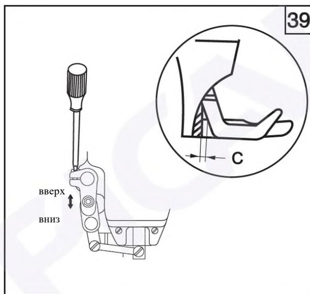
Метод регулировки: сначала ослабьте винт переднего коленчатого вала, а затем поверните ось вверх, тогда шагающая прижимная лапка приблизится к игловодителю. В процессе регулировки, обращайте внимание на заданную величину зазора С.
