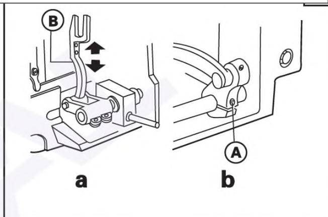
между передним краем зубчатой рейки и выемки игольной пластины должно составлять 1.5 мм. Это стандартное положение для установки зубчатой рейки.
