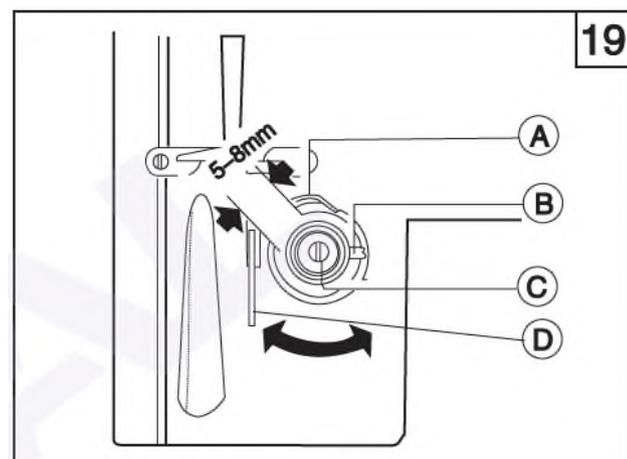
назад и в конце затяните регулировочный винт (А).
