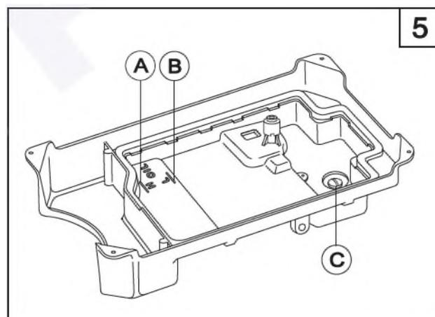
должен быть ниже метки (В), в противном случае может прекратиться подача масла к отдельным частям машины, что приведет к нагреву и заклиниванию.
