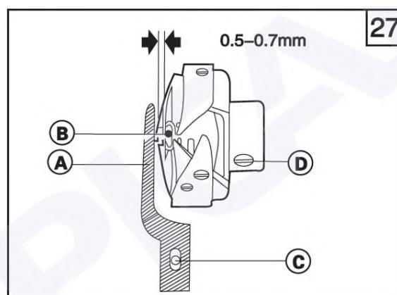
Место установки вращающегося челнока – боковая сторона кончика позиционирующего крюка (A) должна совпадать с боковой стороной иглы (B). Кроме того, зазор между ними должен составлять 0.5~0.7 мм.
