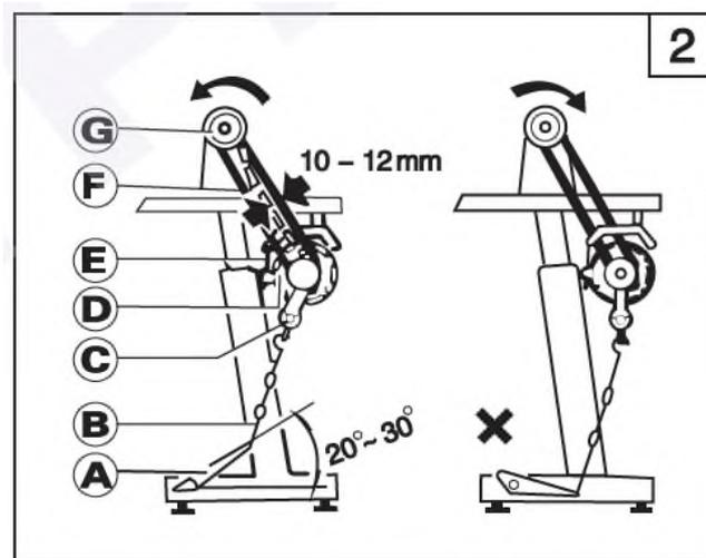
с. Направление вращения швейной машины должно быть против часовой стрелки, если смотреть с внешней стороны ведущего шкива. Направление вращения двигателя должно быть таким же. Изменить его направление на противоположное можно перевернув штепсельную вилку электродвигателя на  $180^{\circ}$ .
