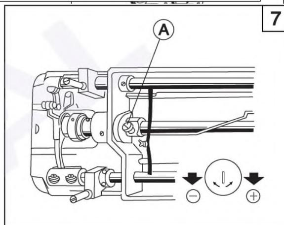
(в направлении знака «-»), то расход масла уменьшится. Винт регулировки количества масла (А) регулирует расход масла в пределах 5 оборотов, если винт затянут, то расход масла максимальный, а если открутить винт на 5 оборотов, то расход масла будет минимальным.
